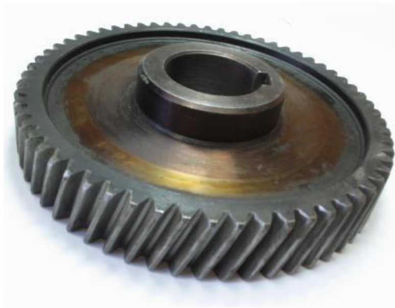
Рисунок 3.2.2 – Зовнішній вигляд косозубого зубчастого колеса
